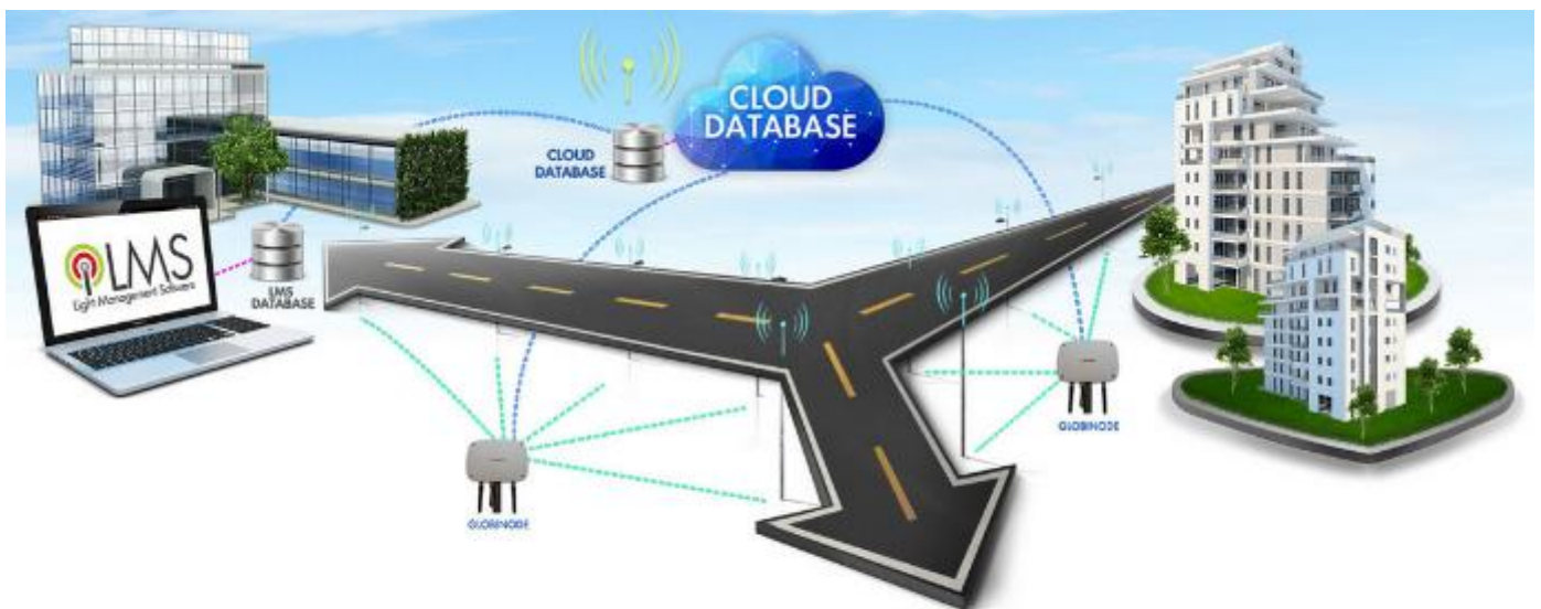
Σύστημα Τηλεδιαχείρισης Λαμπτήρων LED Οδικού Φωτισμού
